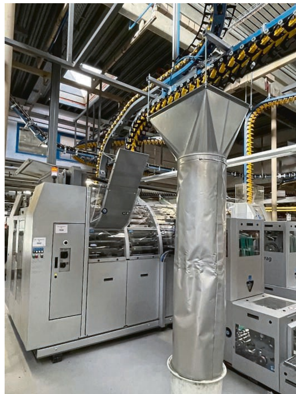
In dieser Trommel werden verschiedene Beilagen in die Ausgaben der Tages- und Wochenzeitungen hineingesteckt.
