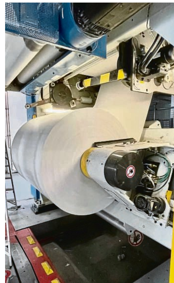
Das Papier für das neue Berliner Format läuft vom sogenannten Rollenträger durch die Drucktürme.
