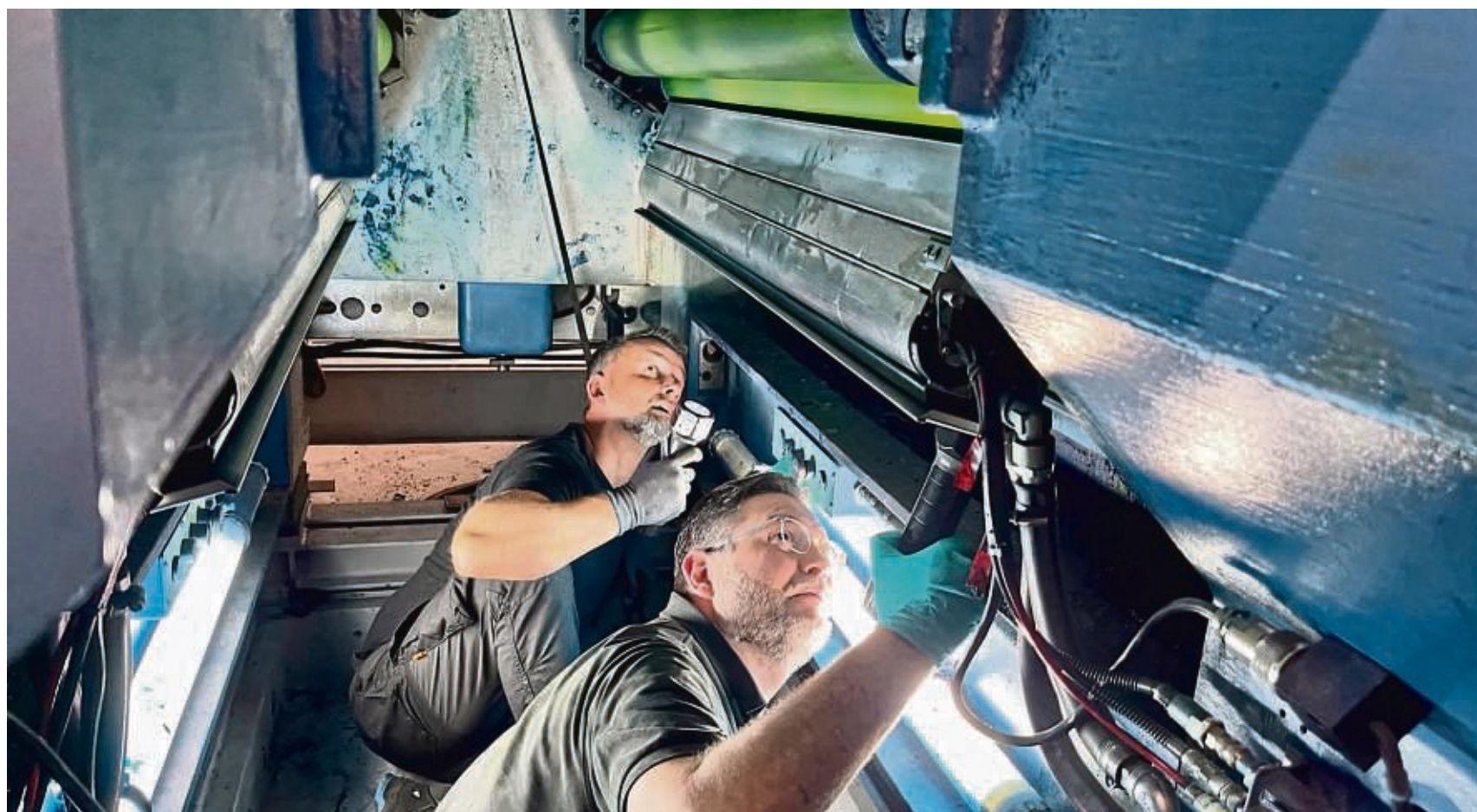
Frank Becker und René Brendel (vorne) justieren die Walzen eines Druckwerks.
