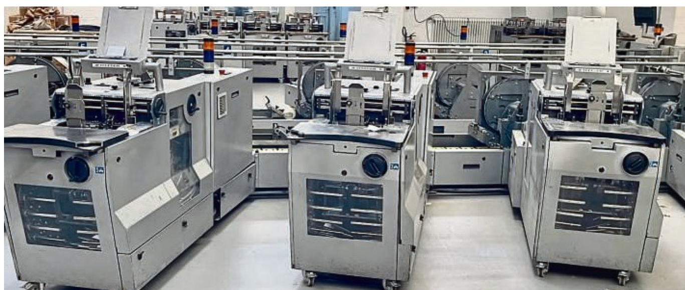
Es gibt in der Produktionshalle insgesamt 16 Stationen, in denen Prospekte oder andere Beilagen eingelegt werden können. Ein Förderband sammelt die Beilagen und transportiert sie in eine Maschine, die diese in die Zeitungen steckt.
